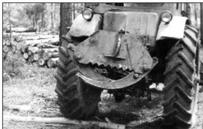
Приспособление для бесчокерной трелевки хлыстов на рубках ухода. Такие установки потом стали изготавливаться на Заринском заводе «Лесхозмаш».
