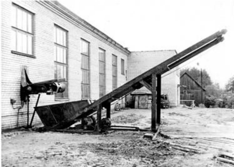
*Рис. 68. Скатовый подъемник для погрузки кусковых отходов на транспортное средство. Заринский лесокOMBинат.*
