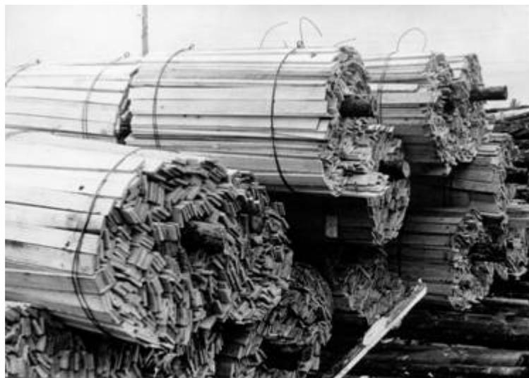
*Рис. 60. Цилиндрические пакеты штакетника, подготовленные к отгрузке. Ларичихинский леспромхоз.*
