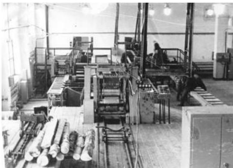
*Рис. 71. Тарный поток в лесопильном цехе Заринского лесокombината. Коротышовая рама обеспечивает работу двух параллельно установленных тарных рам РТ-2.*
