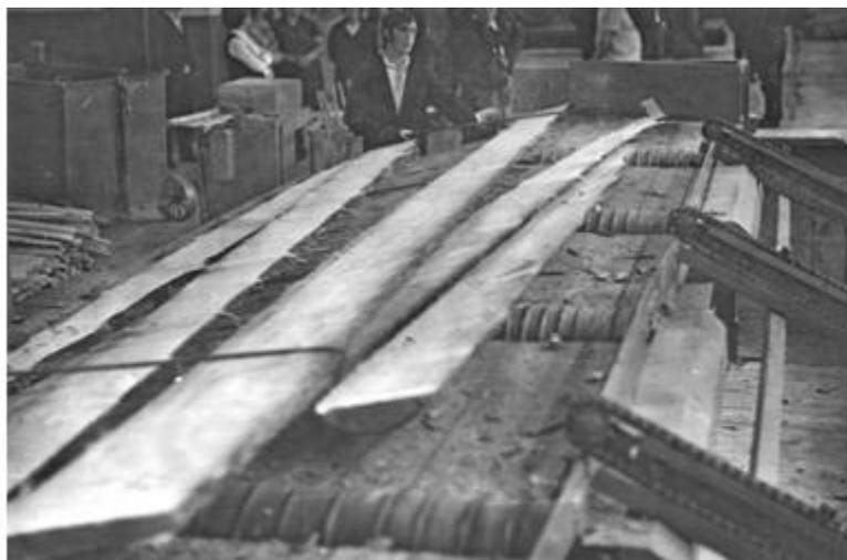
*Рис. 43. Подгорбыльные доски и горбыль винтовым роликами сдвигаются со второй секции рольганга рамы первого ряда на приемный стол торцовочного станка.*
