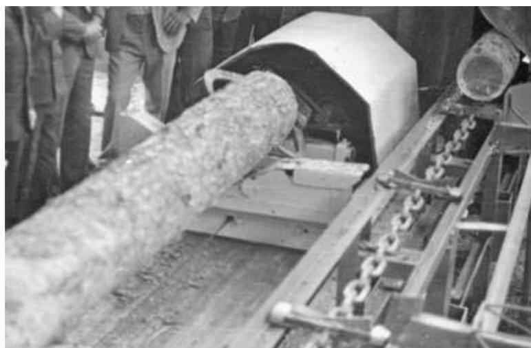
*Рис. 52. Бревна с бревнотаски сбрасывателем сталкиваются на механизированную тележку. Павловский лесхоз.*
