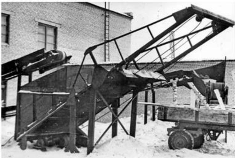
*Рис. 69. Скатовый подъемник. Ковш подъемника может заполняться отходами используя ленточный или скребковый транспортер.*
