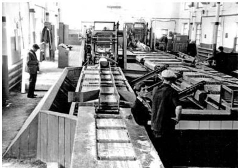
*Рис. 42. Общий вид цеха. Справа - рама первого ряда, слева - рама второго ряда. На снимке видны позадирамные рольганги*
